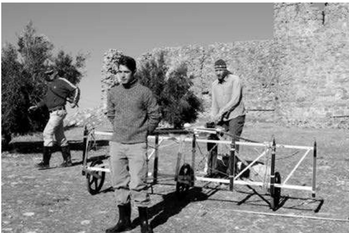
Prospección geofísica con equipo geomagnético de siete sensores.
